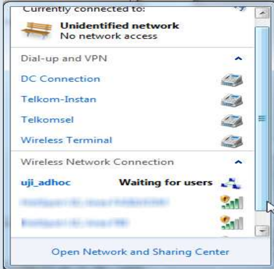
Gambar . Informasi koneksi jaringan wireless Ad Hoc yang telah dibuat
