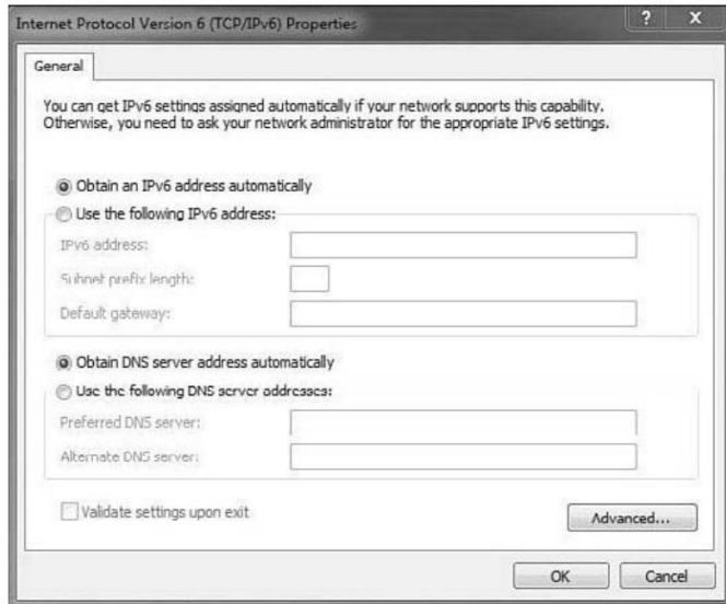
GAMBAR 8-6 Jendela properti Internet Protocol Version 6 (TCP/IPv6) untuk Windows 7
