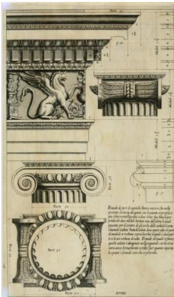
Gambar 2.19 Cornice dan Kapital Order Ionik dengan Spesifikasi Detail (Da Vignola).
