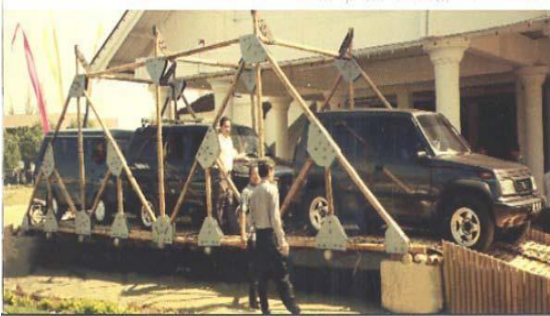
Gambar 1. Pengujian konstruksi jembatan bambu (Morisco, 2006)
