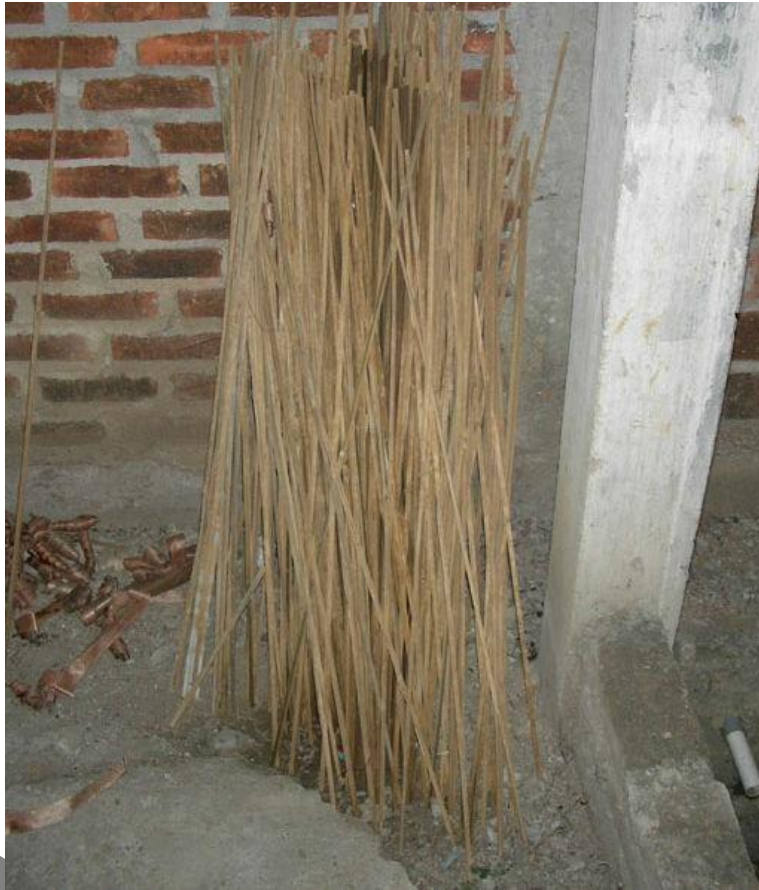
Gambar.12. Komponen bambu sebagai penguat (Sumber : Proceeding ICBS dan Dokumentasi Bpk. Andry Widyowijatnoko)
