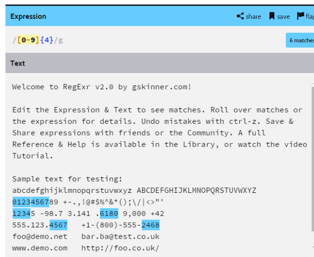
Gambar 2.12. REGEX quantifier dengan kondisi X\{m\}
