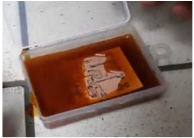
Gambar 4. Proses Penempelan Skema Ke papan PCB dan Perlarutan PCB PCB Assembly → ( https://www.youtube.com/watch?v=sCqOYDUKtYg )
