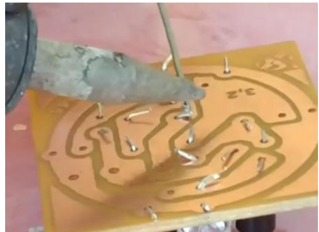
Gambar 5. Proses Pengeboran dan Pemasangan Komponen (Soldering)
