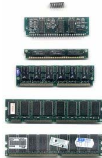
Contoh RAM: DIP, SIPP, SIMM 30 pin, SIMM 72 pin, DIMM, DDR DIMM (dari atas ke bawah)
